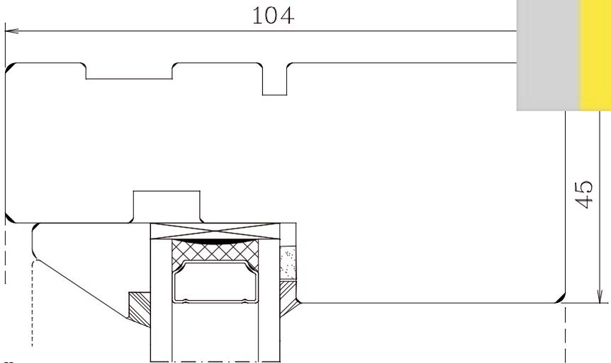
waagerechte Glasleisten gehen durch
